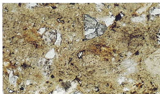
姫路酸性岩（兵庫県加西市高室付近採集）の偏光顕微鏡写真
