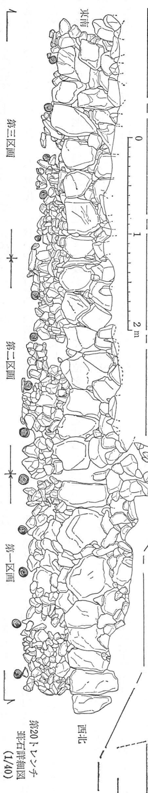
第9図 山辺道上陵トレンチの平面および断面(7)(1/80)、詳細図(1)(1/40)
